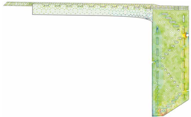
Bild 18. 3D-Modell im Statikprogramm importiert; dargestellt sind die Hauptspannungen in den CPC-Platten (Quelle: CPC AG)
