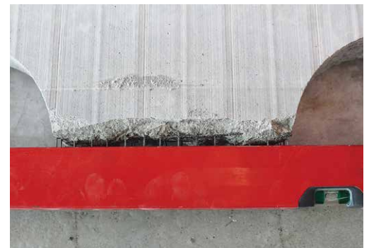
Bild 11. Querdruckversagen des Betons resp. Versagen des Druckgurts im untersten Bereich des Nockens bei einem Keilwinkel von 85° – die zugrunde gelegte Theorie stimmt gut mit den gemessenen Werten überein (Quelle: Masterarbeit Michèle Bühler)
