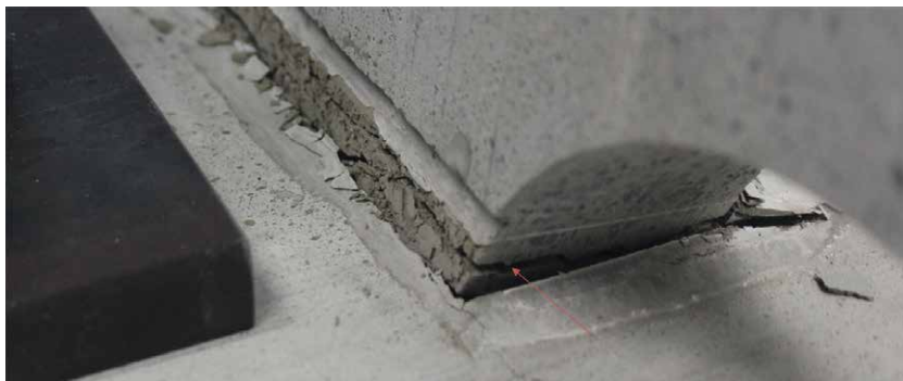
Bild 10. Biegeversagen des Stegs oberhalb der Verbindung auf Höhe der Biegetragfähigkeit der Platte (Quelle: Masterarbeit Michèle Bühler)
