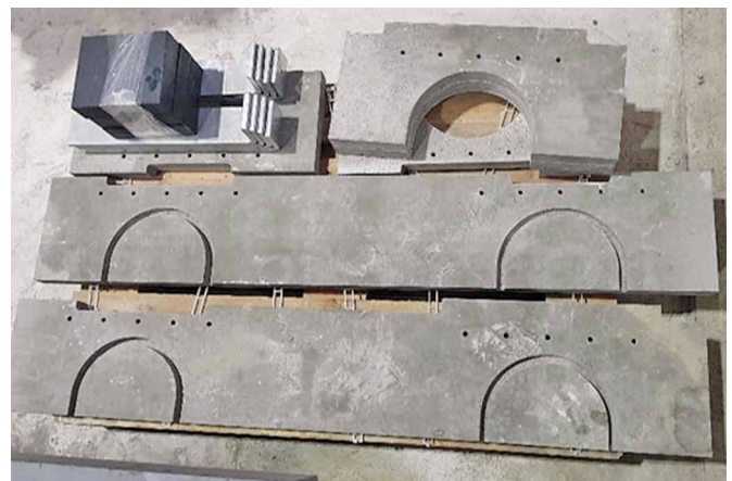
Bild 12 Zugeschnittene Querstege der Hybridbrücke Cut crossbars of the hybrid bridge (ZHAW)
