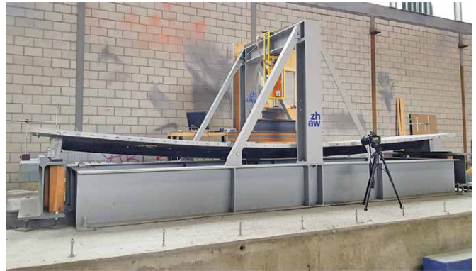
Bild 9 Versuch 1: Vier-Punkt-Biegeversuch des gesamten Hybridträgers Experiment 1: Four-point bending test of the entire hybrid beam (ZHAW)
