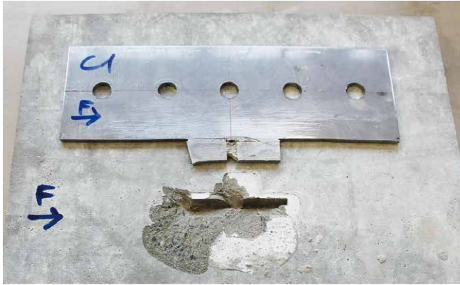
Bild 7 Verbindungsversuch mit Plastifizierung des Stahlhockens und nachträglichen Abplatzungen im Beton Connection test with plastification of the steel cam and subsequent spalling in the concrete (ZHAW)
