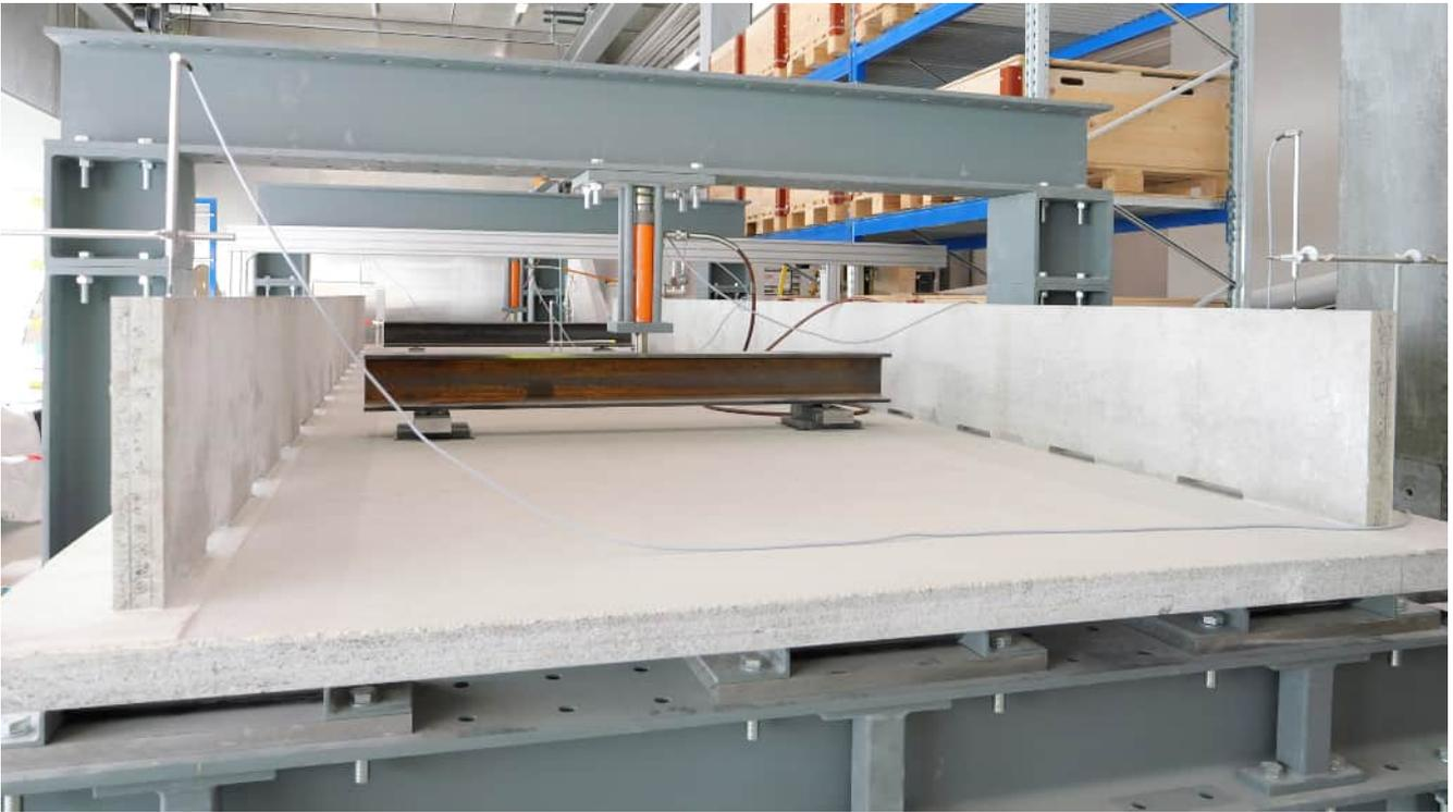
Abbildung 8: äquivalente Flächenlast
