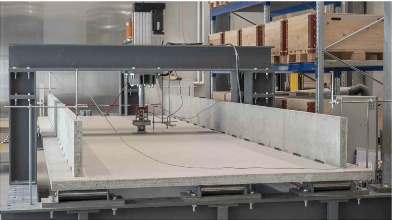
Abbildung 6: Punktlast in Mitte
